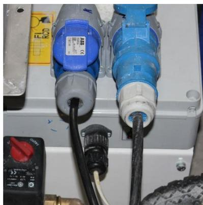
Дополнительные разъемы, смонтированные на панели управления растворонасоса.
